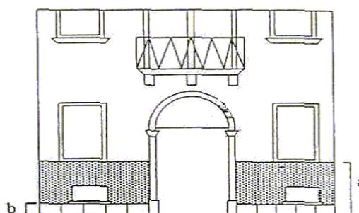
Per la fascia al piano terreno è consentito l'uso di intonaci diversi da quelli adottati nella porzione superiore della facciata. In particolare vanno privilegiati gli intonaci a base di sabbia e calce, tirati a frattazzo e traspiranti. Sono da escludere gli impasti con componenti sintetici o plastici.
