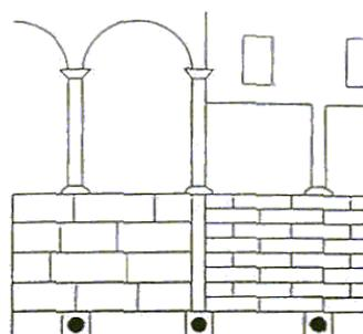
Per i portici di edifici che non hanno valore storico, isolati o che non appartengono ad una sequenza edilizia sono consentiti: trattamenti con materiali compositi, disegni con lastre quadrangolari e in generale tramature che non si ispirino alla pavimentazione storica.
