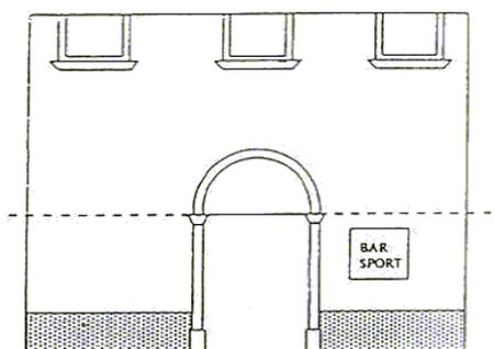
In presenza di foro vetrina ad arco o ad arco ribassato, il limite superiore massimo corrisponde all'asse del marcia alto.
