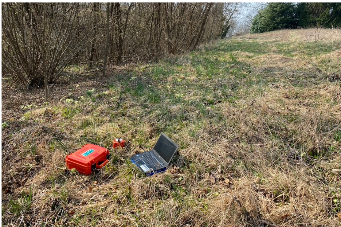
Figura 3 - Esecuzione prova sismica HV02
