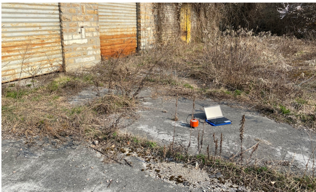
Figura 2 - Zona di progetto durante la prova sismica HV01
