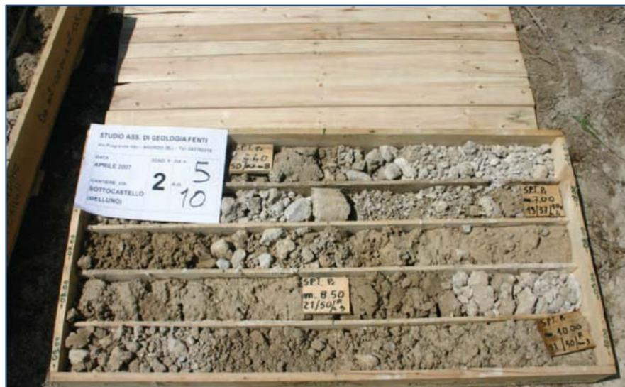
*Figura 40 - Ghiaie e sabbie limose-argillose giallastre della Formazione delle alluvioni limo sabbiose (da Relazione geologica Dissesti di via Sottocastello - Dr. Chiesurin)*
