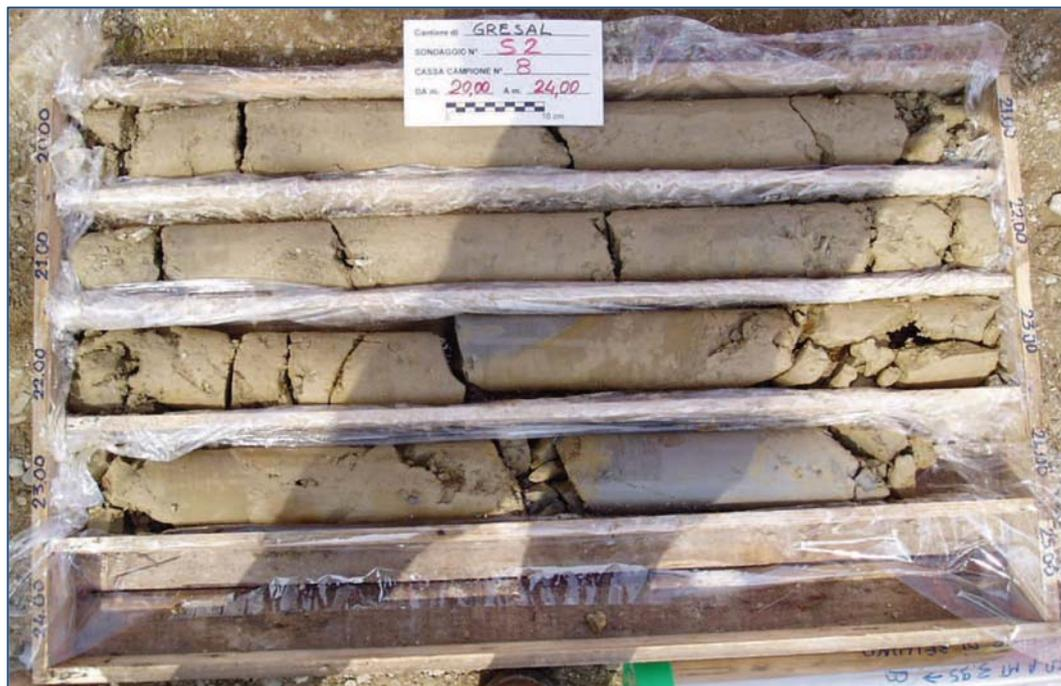
*Figura 44 - limo argilloso- sabbioso della formazione Alluvionale al contatto con le Siltiti Marnose della "Formazione litostratigrafica del Flysch di Belluno" a -22m (da Relazione geologica Ponte Gresal - Dr.ssa Pasetto)*
