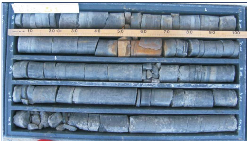
*Figura 43 – Marne, calcari marnosi e calcareniti della “Formazione litostratigrafica del Flysch di Belluno” (da Relazione geologica ATER loc. Levego Via Meassa - Dr. Ennio da Roit)*
