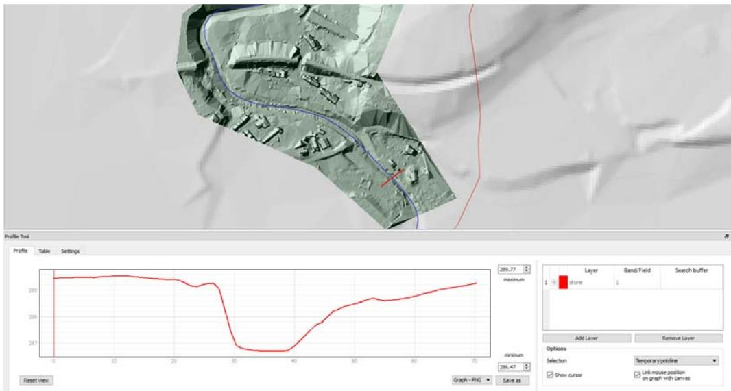
Figura 7-7 – Geometria della sezione del Torrente Gresal alla chiusura del Bacino Idrologico.
