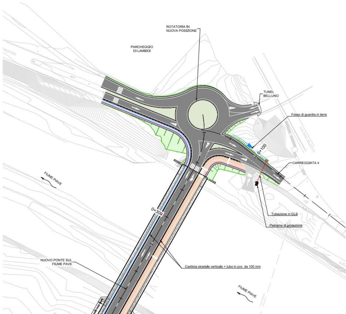
Figura 6. Pianta del drenaggio di piattaforma nella la campata principale e nella sponda destra.
