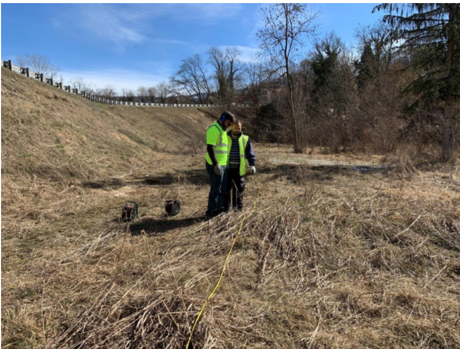
Scoppio con cannoncino (fucile sismico) - SRT 1 in onde P e S
