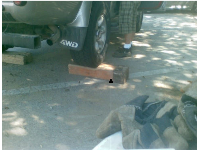
Fig. 4 - Sistema di energizzazione DH per onde S.
