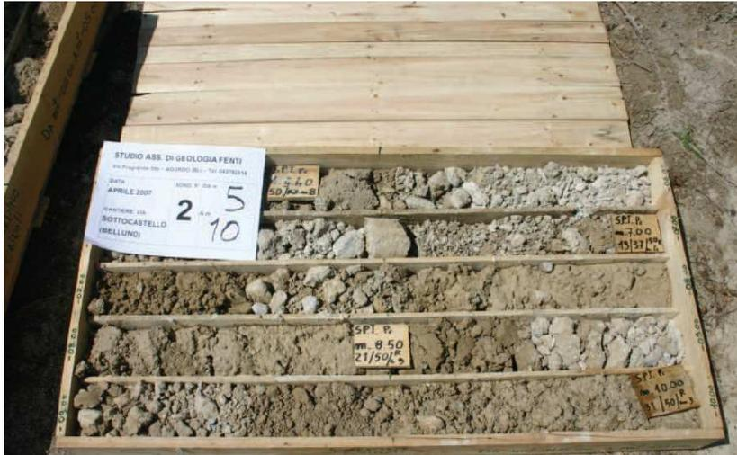
FOTO N.2: Ghiaie e sabbie limose-argillose giallastre della Formazione delle alluvioni limo sabbiose (da Relazione geologica Dissesti di via Sottocastello - Dr. Chiesurin)
