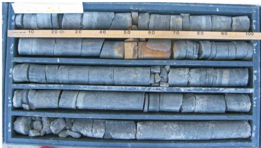
*FOTO N.5: Marne, calcari marnosi e calcareniti della "Formazione litostratigrafica del Flysch di Belluno" (da Relazione geologica ATER loc. Levego Via Meassa - Dr. Ennio da Roit)*
