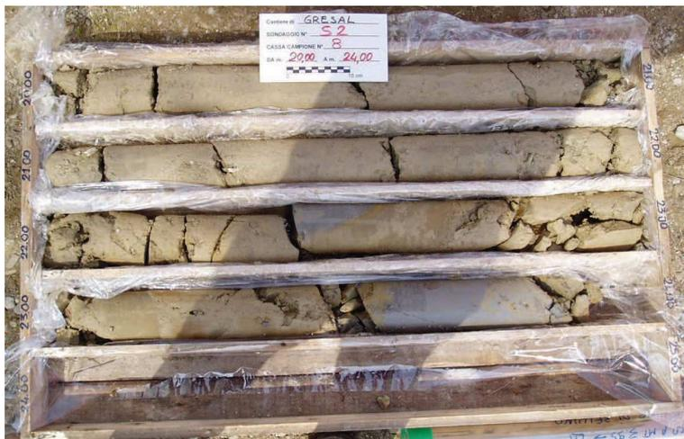
FOTO N.6: limo argilloso- sabbioso della formazione Alluvionale al contatto con le Siltiti Marnose della "Formazione litostratigrafica del Flysch di Belluno" a -22m (da Relazione geologica Ponte Gresal - Dr.ssa Pasetto)
