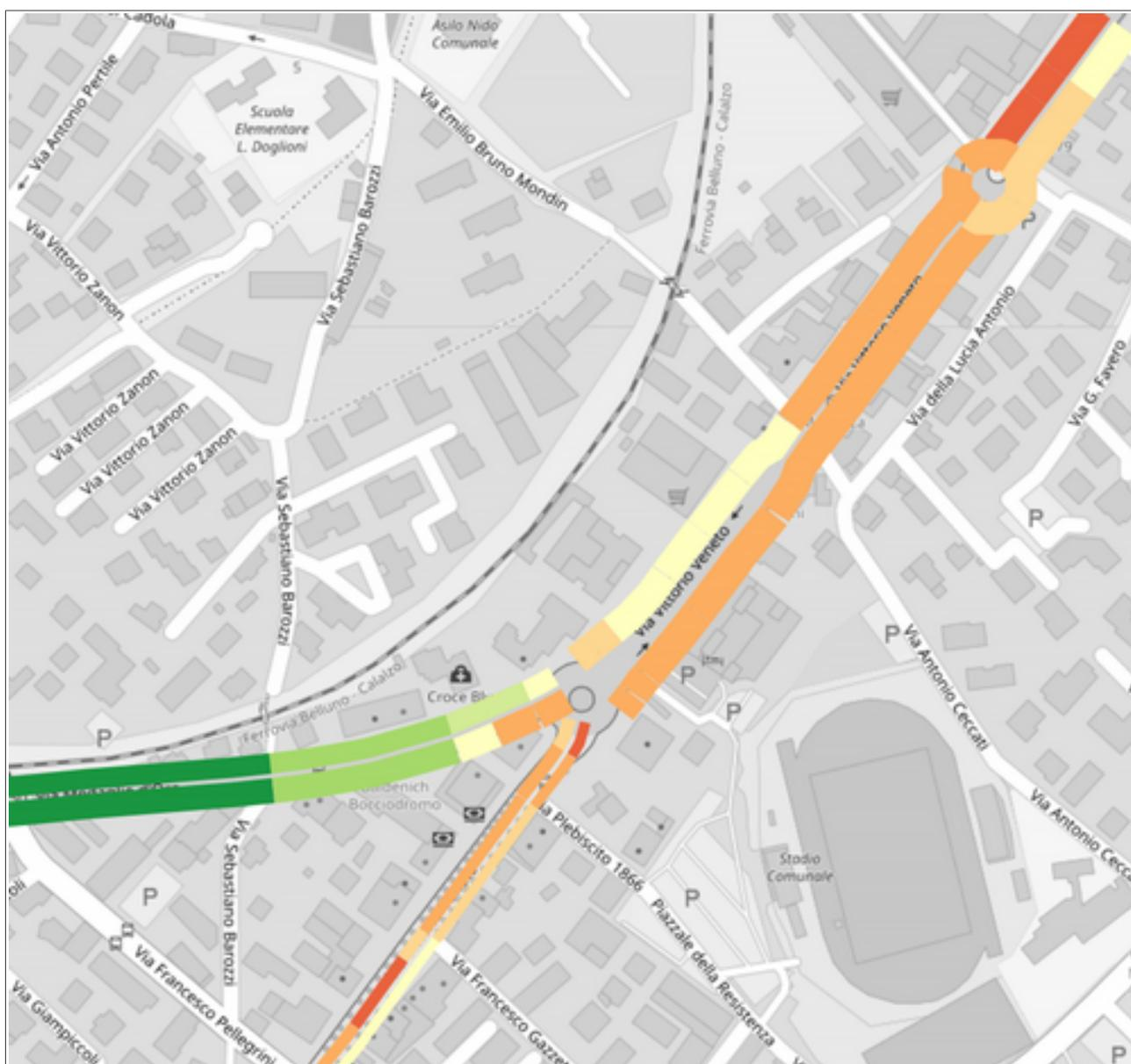
Figura 4.9 - Dimensione del campione e variazione per tratti della velocità di percorrenza relativa al 50° percentile nell'intervallo della mattina 17.00-18.00. Fonte: rappresentazione dati TOMTOM Move su base Openstreetmap.
