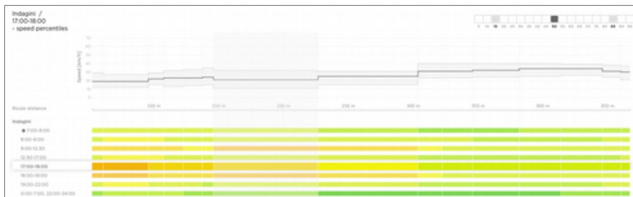
Figura 11.7 - Variazione delle velocità nella fascia oraria 17.00-18.00 del periodo di indagine di luglio 2022, con rappresentazione dei dati al 15°, al 50° e al 85° percentile. Dettaglio per fascia oraria al 50° percentile. Fonte: Dati TOMTOM Move.
