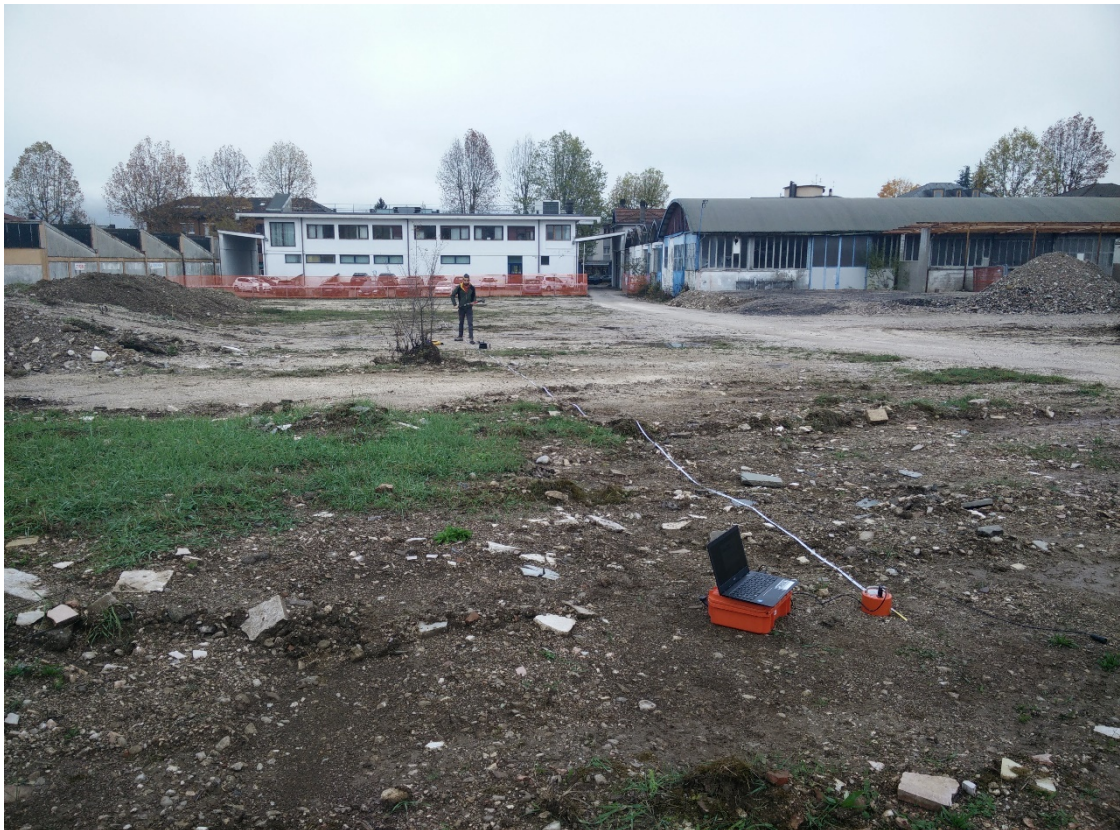
Figura 7 - Esecuzione indagine MASW
