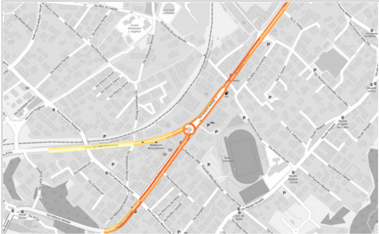
Figura 4.11 - Variazione per tratti della velocità di percorrenza relativa al 85° percentile nell'intervallo del pomeriggio 16.00-19.00. Fonte: rappresentazione su base Openstreetmap.
