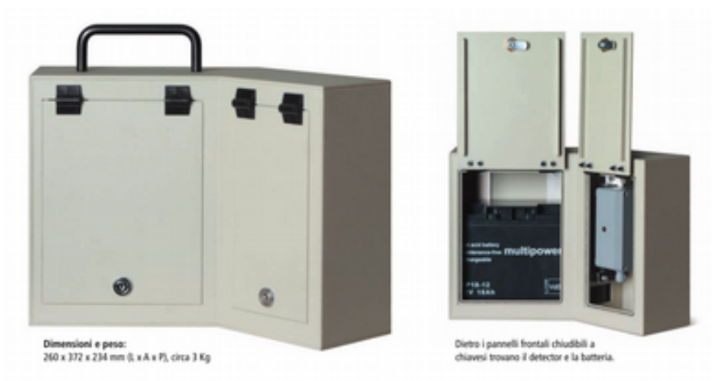
Figura 3.1 - Visualizzazione esterna ed interna dell'apparecchiatura Viacount.
