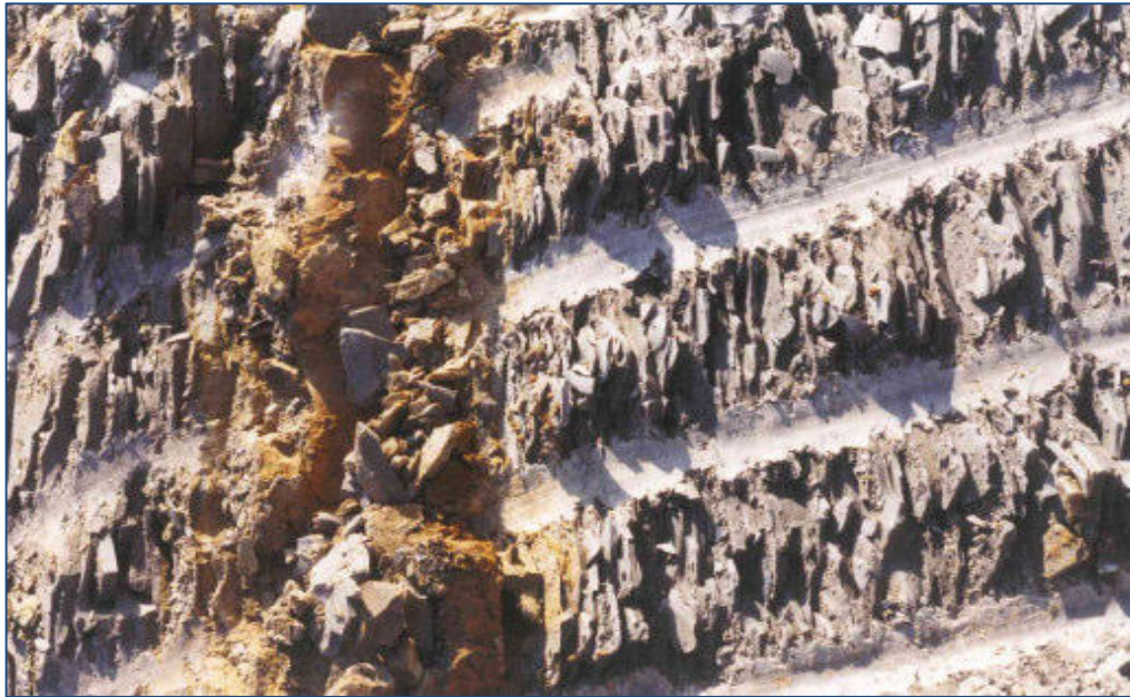
Figura 42 – particolare delle Marne, calcari marnosi e calcareniti della “Formazione litostratigrafica del Flysch di Belluno” (FONTE: Comune di Belluno - Relazione geologica ATER loc. Levego area PEEP Dr. De Biasi)
