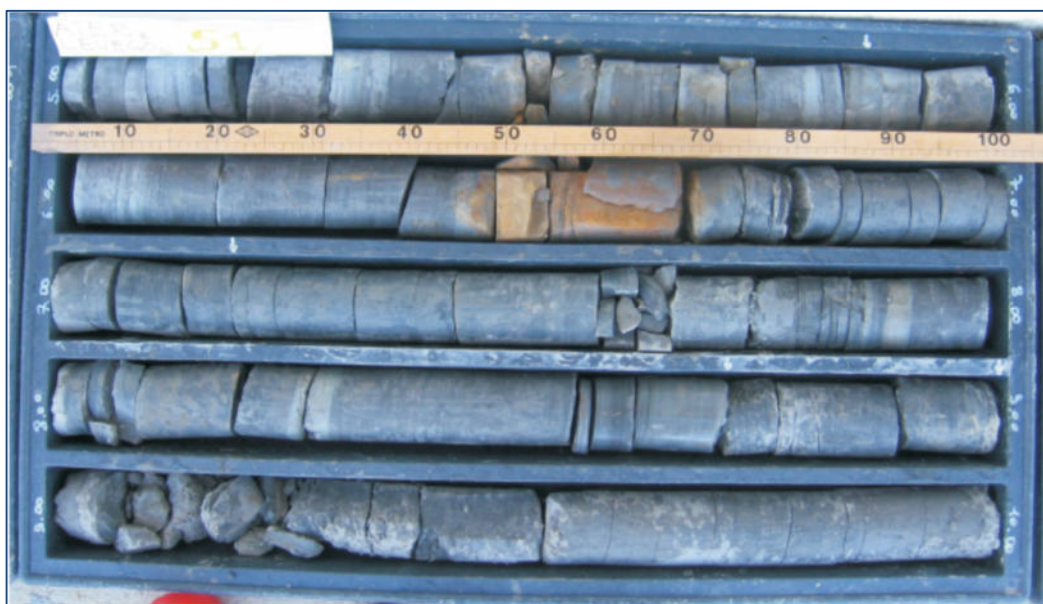
Figura 43 – Marne, calcari marnosi e calcareniti della “Formazione litostratigrafica del Flysch di Belluno” (FONTE: Comune di Belluno - Relazione geologica ATER loc. Levego Via Meassa - Dr. Ennio da Roit)
