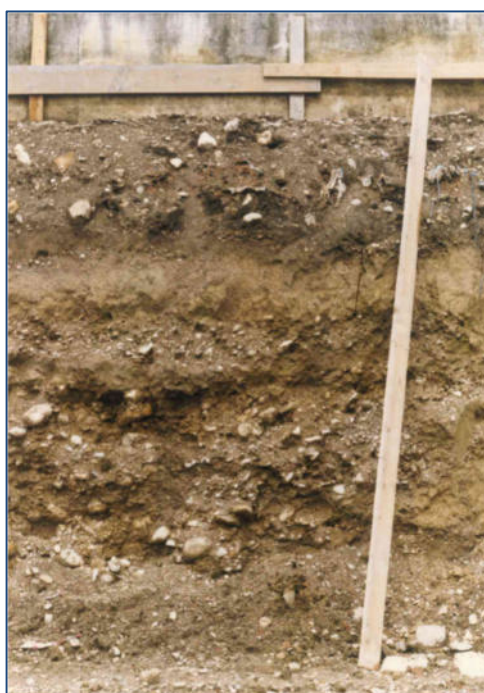
Figura 39 – limi sabbiosi e ghiaie alluvionali (FONTE: Comune di Belluno - Studio geologico per IACP in loc. Cavarzano Dr.Colleselli)
