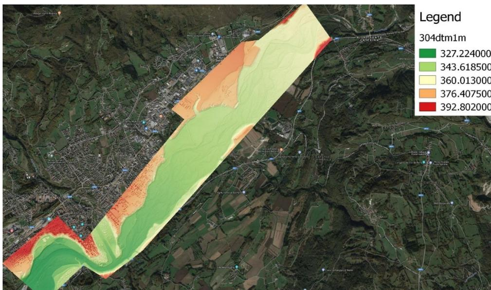
Figura 9-5 – DTM del fiume Piave in corrispondenza della zona di intervento
