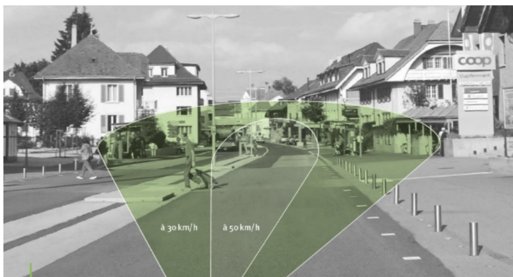
Figura 8-12 Apertura del cono visivo viaggiando a 30 km/h o a 50 km/h
