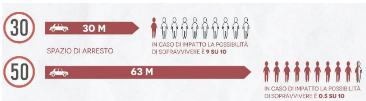
Figura 8-11: Possibilità di sopravvivenza in funzione della velocità d'impatto
