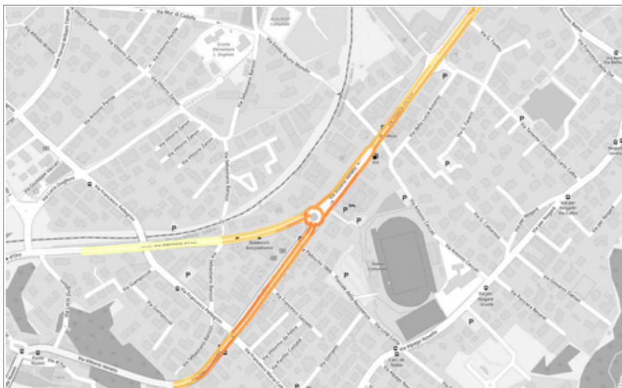
Figura 4.15 - Variazione per tratti della velocità di percorrenza relativa al 85° percentile nell'intervallo della mattina 7.00-10.00 . Fonte: rappresentazione dati TomTom su base Openstreetmap.
