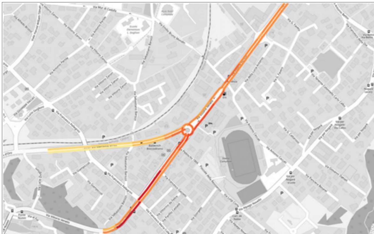
Figura 4.14 - Variazione per tratti della velocità di percorrenza relativa al 50° percentile nell'intervallo della mattina 7.00-10.00 . Fonte: rappresentazione dati TomTom su base Openstreetmap.
