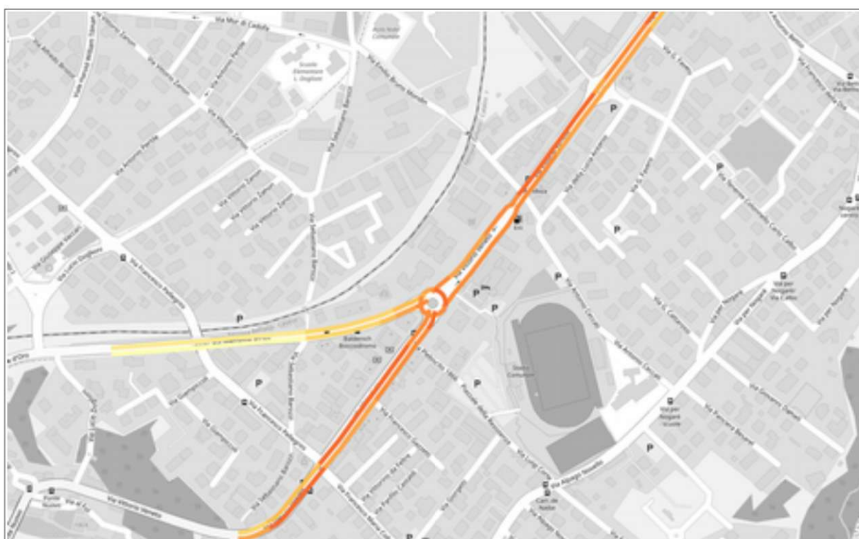
Figura 4.17 - Variazione per tratti della velocità di percorrenza relativa al 85° percentile nell'intervallo del pomeriggio 16.00-19.00. Fonte: rappresentazione dati TomTom su base Openstreetmap.
