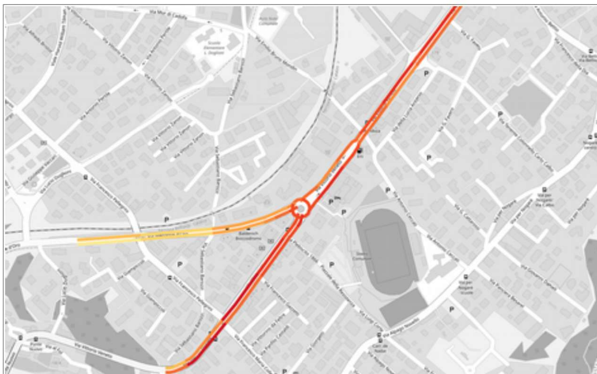
Figura 4.16 - Variazione per tratti della velocità di percorrenza relativa al 50° percentile nell'intervallo del pomeriggio 16.00-19.00. Fonte: rappresentazione dati TomTom su base Openstreetmap.
