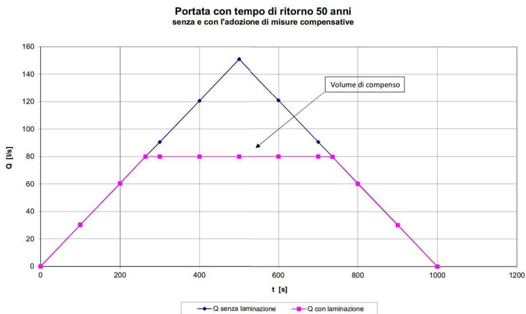
**Figura 5** - *Diagramma della portata prevista in uscita nello stato di progetto senza l'adozione di misure compensative, e portata laminata al valore massimo di 80 l/s (portata nello stato di fatto), a seguito della realizzazione di volumi compensativi.*
