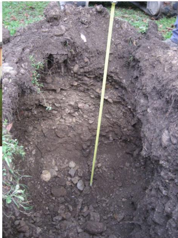
Foto 2 – Dettaglio dello scavo esplorativo da cui si evince la presenza di terreni eterogenei in abbondante matrice fine e soprattutto la presenza di una vena idrica a circa 80 cm dal p.c..
