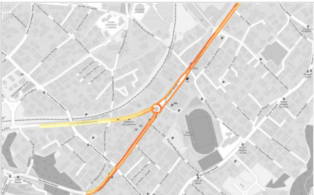
Figura 4.17 - Variazione per tratti della velocità di percorrenza relativa al 85° percentile nell'intervallo del pomeriggio 16.00-19.00. Fonte: rappresentazione dati TomTom su base Openstreetmap.
