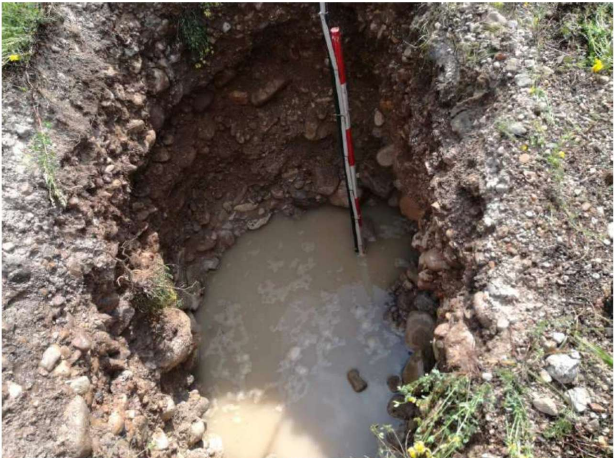
Foto 4: Trincea di scavo durante l'esecuzione della prova di permeabilità
