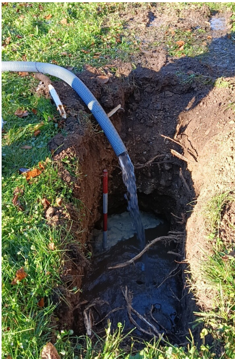
Foto 4: Esecuzione della prova di permeabilità – Fase di carico
